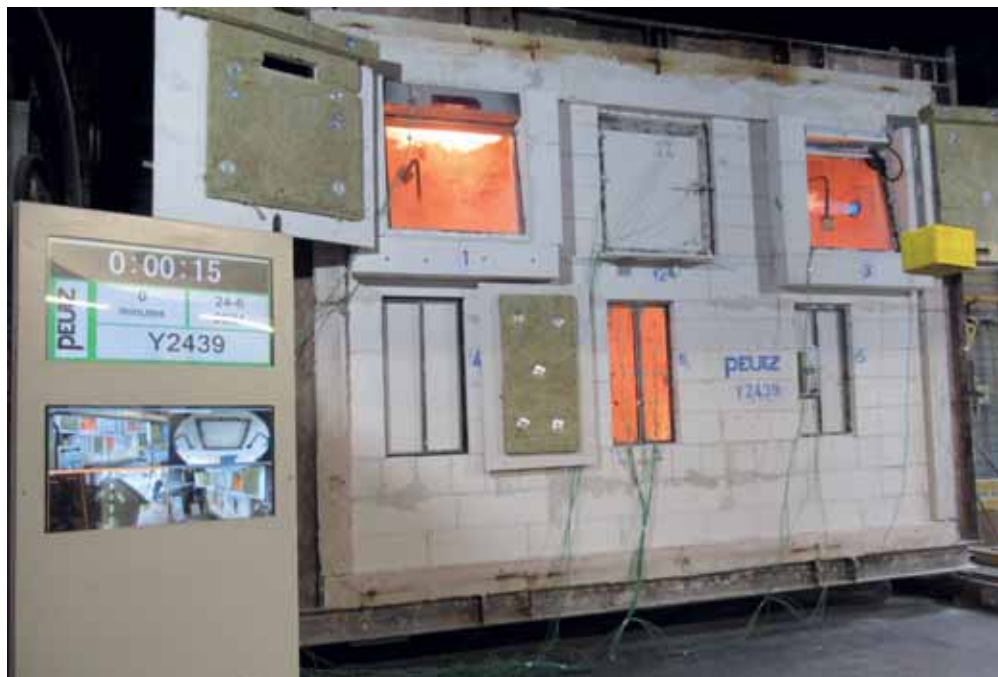
Foto 2. Brandwerendheidstest hang- en sluitwerk EN 1634-2 voor MHB.
