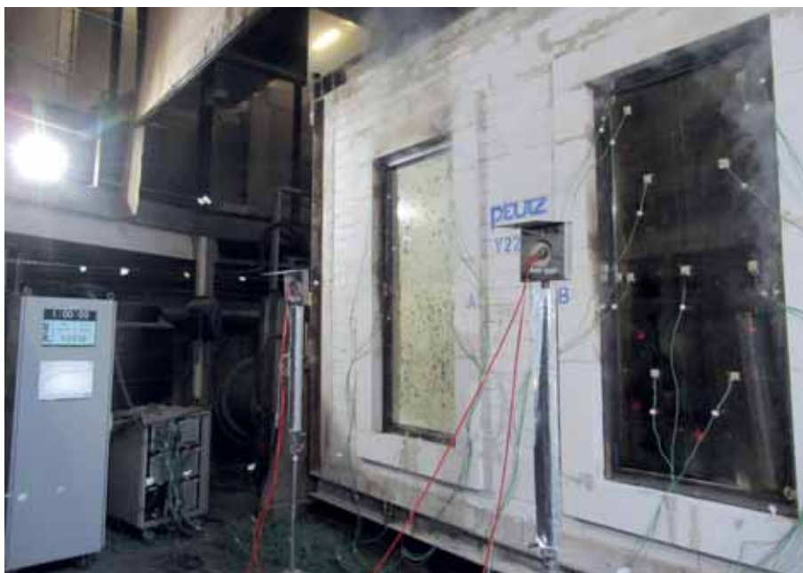
Foto 4. Brandwerendheidstest te openen ramen met triple glas EN 1634-1 voor Forster Nederland.
