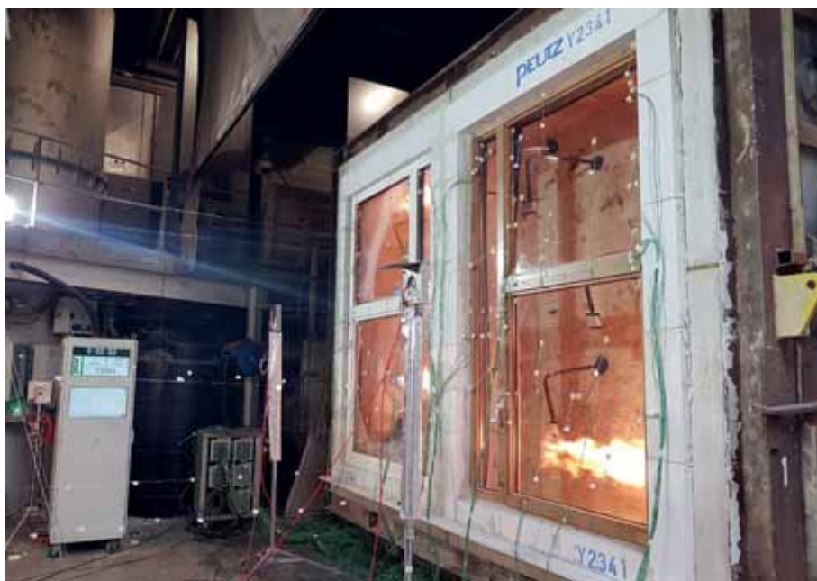
Foto 1. Brandwerendheidstest hout-aluminium raamconstructie voor WEBO.
