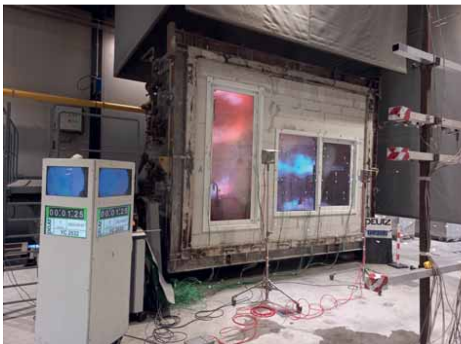
Foto 3. Brandwerendheidstest EN 1634-1 kunststof systemen voor Profine.
