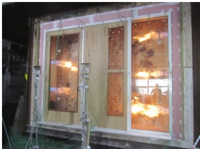
Bij een deurentest mag in het direct toepassingsgebied het glas van de zijlichten niet worden vergroot.
