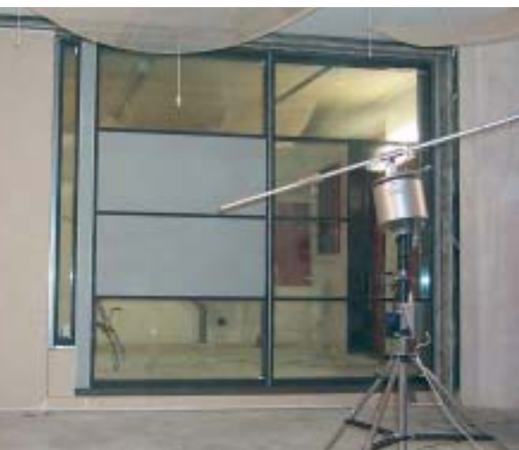
Figuur 2. Voorbeeld van een te onderzoeken samengestelde wandconstructie geplaatst in het Laboratorium voor Akoestiek van Peutz bv.
