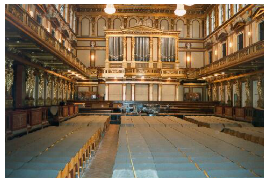
Abbildung 8: Praktische Anwendung des Publikumssimulationsstoffes bei der raumakustischen Messung des Wiener Musikvereinssaales
