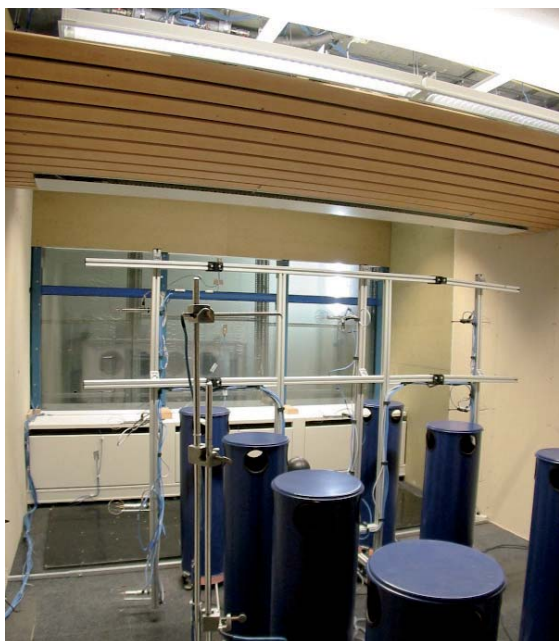
9. Proefkamer met een lange open actieve unit in gebogen plafondstrook.
