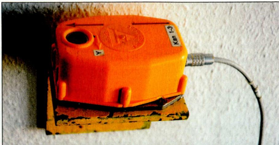
Abb. 4: Triaxialer Fundamentmesspunkt (x, y und z-Richtung)
