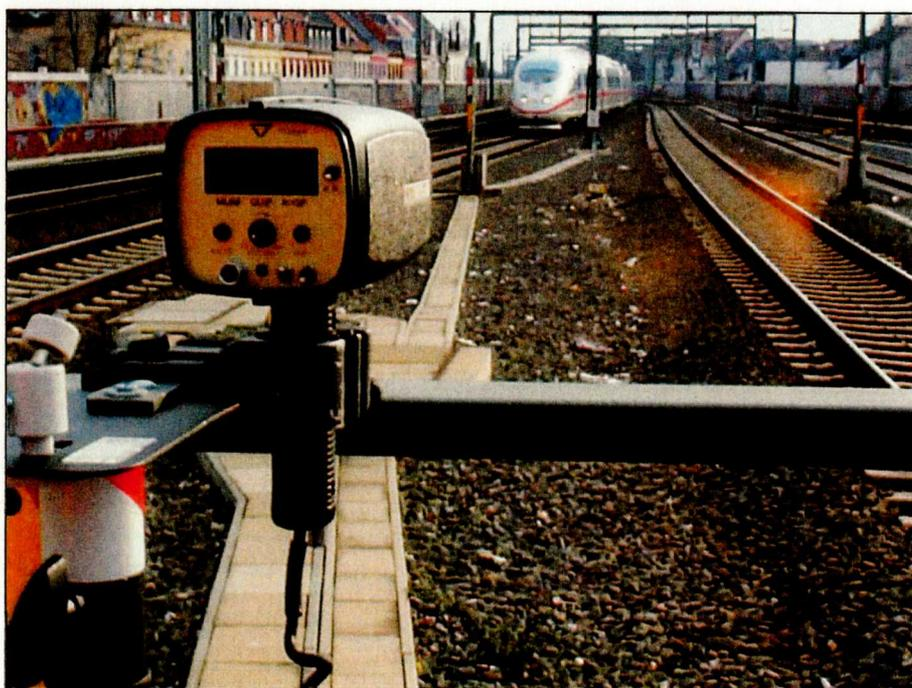
Abb. 3: Messung der Zuggeschwindigkeit mit einem Radarmessgerät
