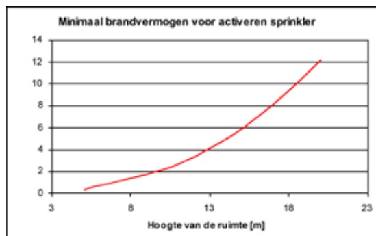
Figuur 1: Minimaal benodigd brandvermogen voor activeren sprinkler
