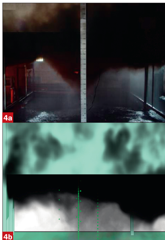
Rooklaagontwikkeling 640 kW brand. Sprinklerdruk 0,09 MPa. 4a: rooklaag tijdens experiment, 4b: CFD berekening rooklaag
