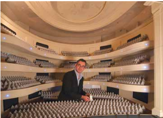
Akustikmodell im Maßstab 1:10: Hier maß der Autor die Schallabsorption der Bestuhlung, um sie an die Anforderungen anpassen zu können
