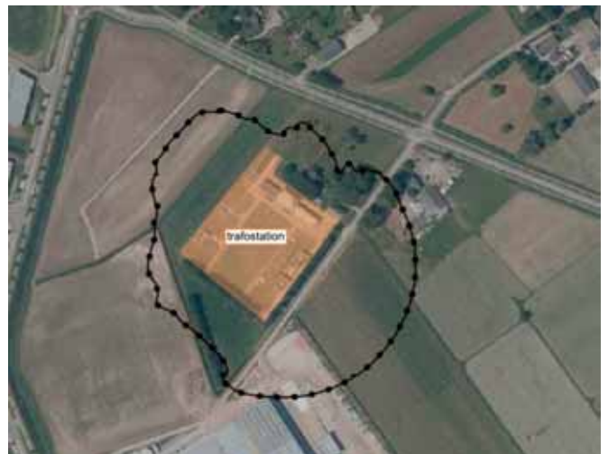
FIGUUR 2: VOORBEELDSITUATIE VAN EEN SOLITAIR TRAFOSTATION OP EEN GEZONEERD INDUSTRIETERREIN WAARBIJ EEN TOESLAG VANWEGE TONAAL GELUID KAN WORDEN TOEGEPAST
