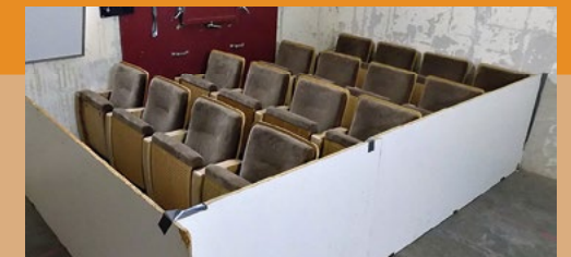
Meting van de geluidabsorptie van de stoelen in het akoestisch laboratorium
