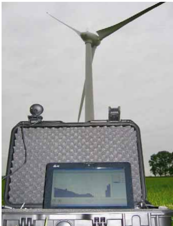
FIGUUR 8: STEEKPROEFSGEWIJZE GELUIDMETING BIJ EEN WINDTURBINE OP LOCATIE
