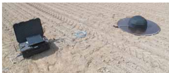
FIGUUR 3: MEETOPSTELLING MET MEETPLAAT EN GEKALIBREERDE WINDBOLLEN
