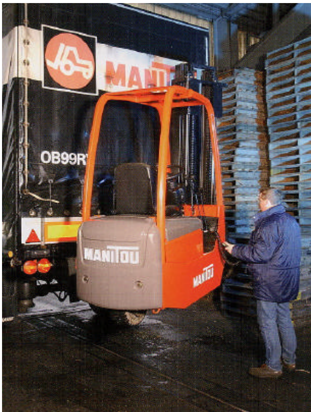
figuur 5: Stille meeneemheftruck (elektrisch aangedreven in plaats van brandstofmotor; Manitou)
