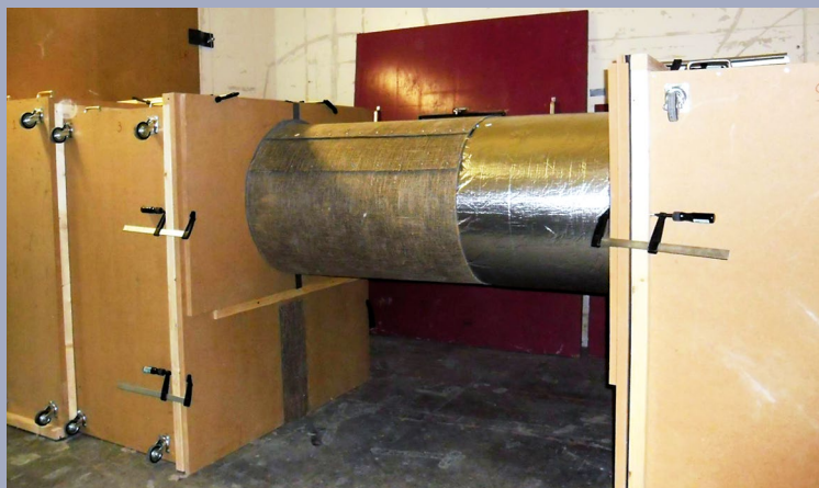
Onderzoek naar geluiduitstraling van kanalen met diverse isolatiematerialen
